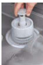
**ARCHIMEDES:** Pendant le rinçage, de l'eau propre est introduite dans la cuve pour remplacer l'eau sale. Avec un déversoir traditionnel, de l'eau propre flotte sur l'eau sale, qui pèse davantage. Par conséquent, sur les trois litres introduits, un litre va directement dans le siphon. Notre technologie repose sur le principe des vases communicants et réduit les pertes de 38% à 17%.
