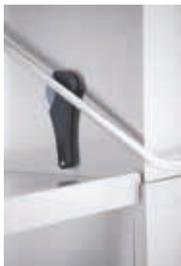
**PROGLIDE:** Die Haube gleitet leicht auf reibungsarmen Schienen und wird durch ein Hebelsystem betätigt, ohne asymmetrisches Verschieben und Verklemmen, auch wenn der Griff im Winkel gehalten wird. Durch ein Gegengewicht beträgt die Kraft für das Anheben nur 3 kg. Das Personal muss sich weniger anstrengen und arbeitet produktiver. Um die Wärme- und Schallabgabe zu verringern, ist die Haube doppelwandig und isoliert.
