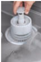
**ARCHIMEDES:** System zur "Reinigung des Spülwassers", mit dem gegenüber einer gleichartigen Maschine mit herkömmlichem Überlauf zirka 10% der Reinigerkonzentration im Tank eingespart werden kann. Es sind zwei unabhängige Filter vorhanden: ein grobes Tanksieb aus Edelstahl oder glasfaserverstärktem Verbundmaterial für große Schmutzpartikel sowie ein Feinfilter vor der Pumpe. Das Ablaufsystem weist eine Wirksamkeit von 83% für den Wasseraustausch gegenüber 66% bei herkömmlichem Überlauf auf.
