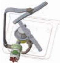
**DUO FLO:** Eine herkömmliche Pumpe besitzt einen Einlass (vom Tank) und einen Auslass zu den zwei Spülarmen: der Wasserfluss muss durch eine T- oder Y-Verbindung geteilt werden. Nach unseren Forschungen gehen hier 25–30% der Leistung verloren. Die Lösung von Repagas ist einfach: die Pumpe besitzt einen Einlass, aber zwei Auslässe, ohne T-Weiche. Der Verlust wird verringert, es gibt keinen Druckverlust, und auch die Störgeräusche werden auf die Hälfte reduziert.
