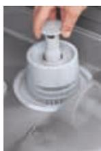
**ARCHIMEDES:** Durante el aclarado, se introduce agua limpia en la cuba para sustituir la sucia. Con un rebosadero tradicional, el agua limpia flota sobre la sucia, que pesa más; en consecuencia, por cada tres litros introducidos, uno termina directamente en el desagüe. Nuestra tecnología se basa en el principio de los vasos comunicantes y reduce las pérdidas del 38% al 17%.
