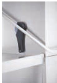
**PROGLIDE:** La capota se desliza suavemente sobre las guías antifricción y se acciona mediante un sistema de palancas, sin desplazamientos asimétricos ni atascos, incluso si el asa se agarra por un lado. El peso está contrabalanceado y el esfuerzo de elevación se reduce a tan solo 3 kg; el personal se cansa menos y la productividad es mayor. Para reducir las emisiones térmicas y acústicas, la capota posee una doble pared con aislamiento.
