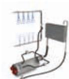
**RINÇAGE CONSTANT PRORINSE:** Il utilise une pompe de rinçage de 200 watts qui garantit une pression et un débit constants de l'eau de rinçage, quelles que soient les conditions d'alimentation du réseau d'eau. Le réservoir est alimenté en eau grâce à un dispositif anti-contamination appelé « break tank » homologué conformément à la norme anglaise WRAS.
