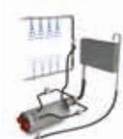
**ACLARADO CONSTANTE PRORINSE:** Utiliza una bomba de aclarado de 200 vatios que garantiza una presión y un caudal constante del agua de aclarado sean cuales sean las condiciones del suministro de la red hídrica. El calderín es alimentado de agua a través de un dispositivo anticontaminación denominado "break tank" homologado según la norma inglesa WRAS.
