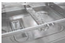
**FILTRES DE CUVE INTÉGRÉS:** Le filtre est composé d'une surface plane, inclinée vers l'extérieur, ce qui facilite le ruissellement des déchets solides, et d'un panier pour la collecte des déchets. Le panier est facile d'accès pour que l'utilisateur puisse le retirer et le vider rapidement.
